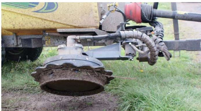
Abb. 6: Mit Hochdruck betriebener Düsenteller des Bodenbearbeitungsgeräts GrassKiller (Caffini S.p.a / Agrartechnik GmbH Dröppelmann).
