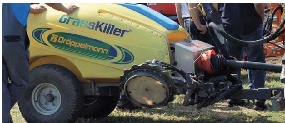
Abb. 15: GrassKiller im Heckanbau mit 1.000 l Wasserfass und verstellbarem Düsenteller.
