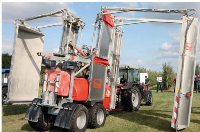
Abb. 20: Rückansicht des zweireihigen Reflektorsprüheräts Wanner NTR20 und Demonstration des Hangausgleichs.
