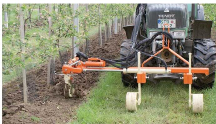
Abb. 9: Mechanische Bodenbearbeitung mit dem Unterschneider Typ Braun (Braun Maschinen GmbH) im Versuchsjahr 2019.
