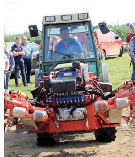
Abb. 14: Zweiseitig arbeitender Krümpler Ladurner im Frontanbau.
