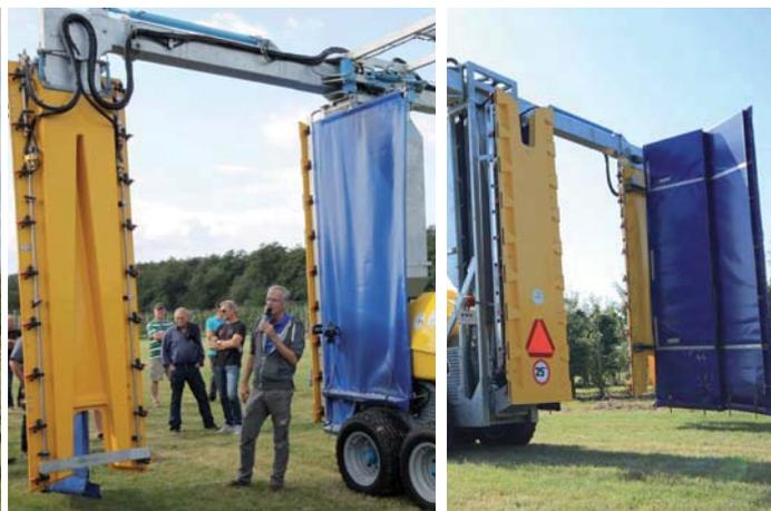
Abb. 21: Das dreireihige Sprüherät KWH 3R2 K1500 mit Ausrüstung von Kollektorwänden für eine Reihe (Anerkennung steht noch aus).
