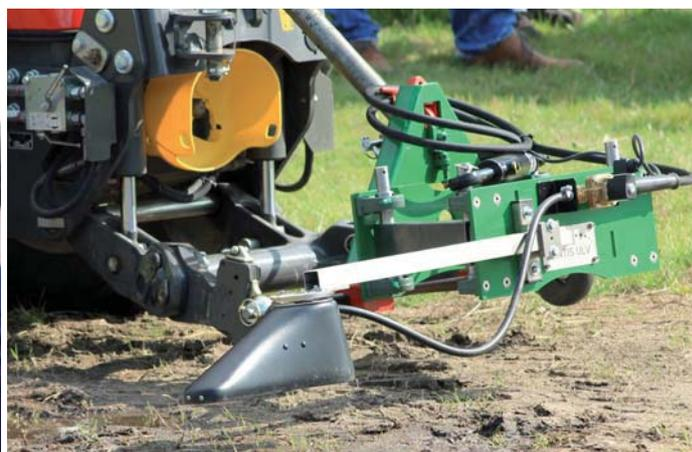
Abb. 17: Erstmalige Präsentation der Mantis Heißwasser Applikationseinheit für den Frontanbau am Schlepper.
