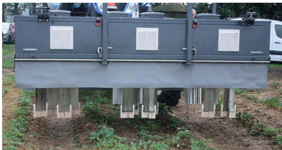
Abb. 10: Versuchsweiser Einsatz des Elektroherb-Geräts (Zasso GmbH) zur Unkraut- und Ausläuferregulierung in Erdbeerbeständen mit Strom.
