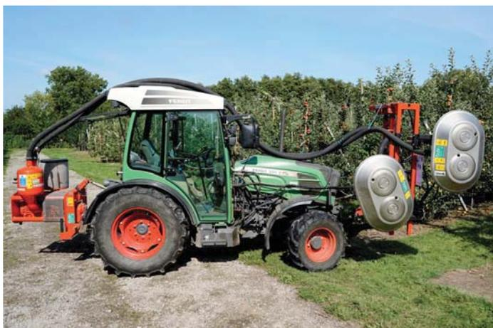
Abb. 1: Entblätterungsgerät der Firma Olmi. (Fotos:ESTEBURG)
